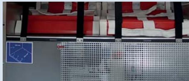
Oberhalb der Rollladen ist über die komplette Aufbau- Breite ein zusätzlicher Stauraum eingearbeitet, der von der Ladefläche aus zugänglich ist.
