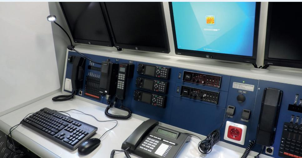
Die Bedien-Elemente werden meist in eine Funkkonsole mit leicht auswechselbaren Modulplatten eingebaut.
