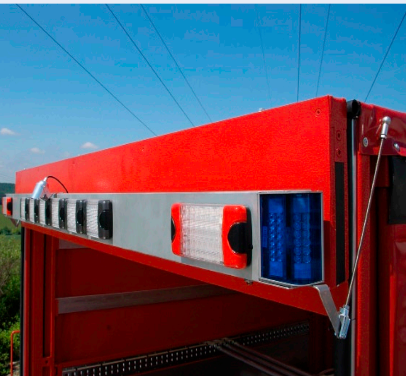
Heckklappe geschlossen - Leuchten geschützt
