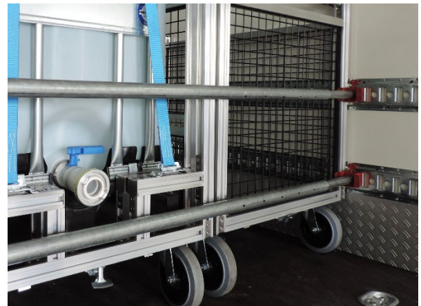
Abb. 10: Schwere Rollwagen im Mittelgang müssen immer mit 4 Sperrstangen gesichert werden (2 vorne, 2 hinten).
